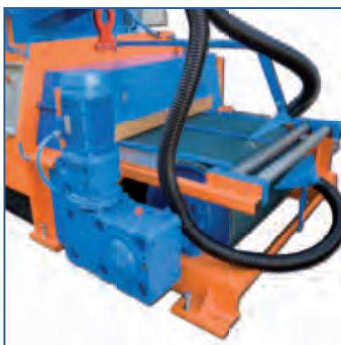
Motoriduttore traino nastro. Zona scarico levigatrice. Belt tow motor reducer, unload area.
