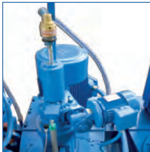
Motoriduttore salita/discesa/pressione di lavoro dell'abrasivo; giunto rotante alimentazione acqua; sensore posizione abrasivo. Upward/ descent motor reducer / abrasive working pressure, rotating joint water feeding, abrasive position of sensor.
