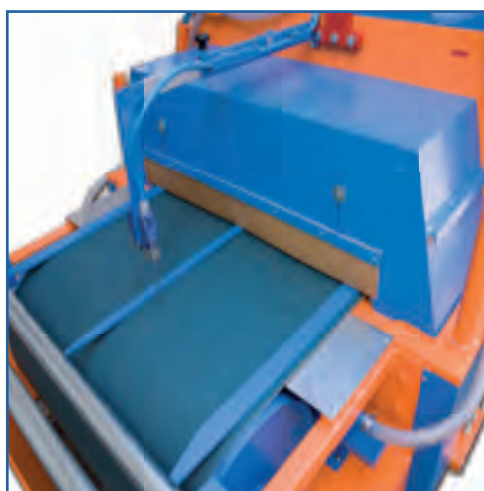
Tubo lavaggio nastro. Zona carico Belt washing pipe. Loading area
