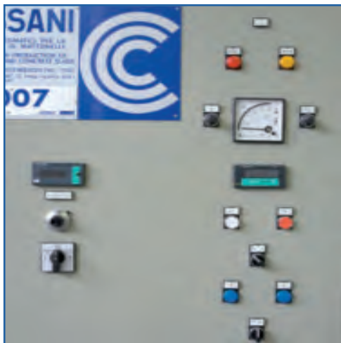
Comando velocità nastro, comando salita/discesa abrasivo, regolazione pressione di lavoro. Belt speed control, abrasive up ward/descent control, working pressure adjustment.
