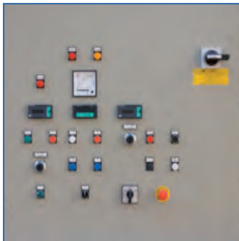
Comando salita/discesa utensile diamantato e visualizzatore di quota. Upward/ descent control of diamond tool and level visualizer.
