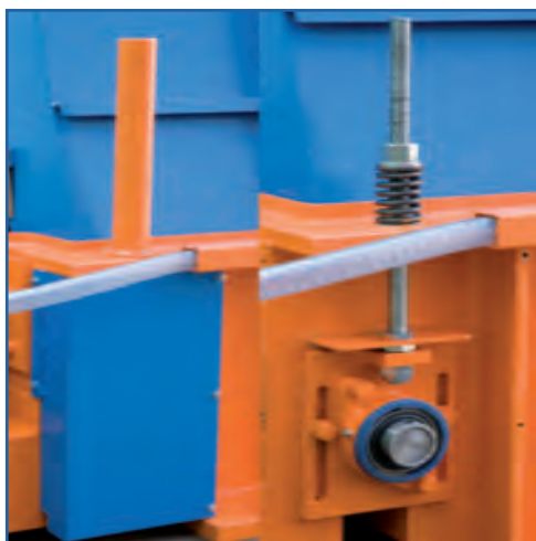
Dispositivo tensione e guida nastro. Tension device and belt guide.
