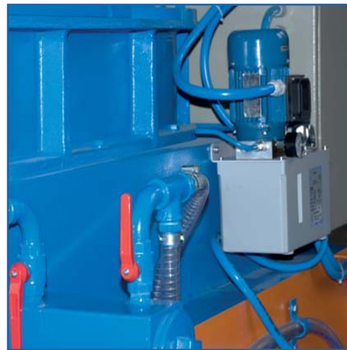
Centred lubrication pump programmable and water feeding. Bomba de lubricación centralizada programable y alimentación del agua.
