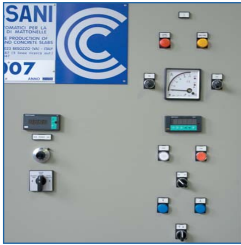
Belt speed control, abrasive up ward/descent control, working pressure adjustment. Control de velocidad de la banda, control de subida/bajada del abrasivo, regulación presión de trabajo.
