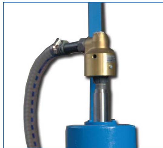
Rotaring joint water feeding, sensor of abrasive position. Junta rotante alimentación agua, sensor posición abrasivo.
