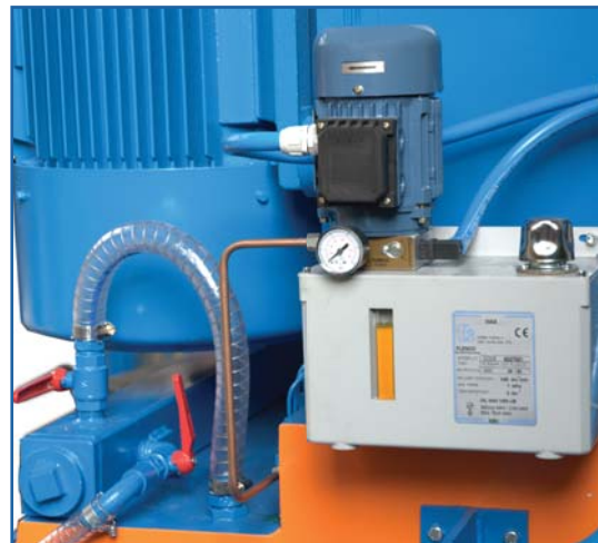
Centred lubrication pump programmable and water feeding. Bomba de lubricación centralizada programable y alimentación del agua.
