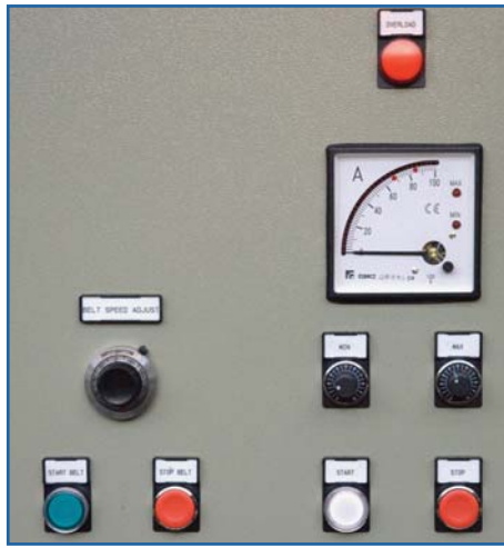
Belt speed control, abrasive up ward/descent control, working pressure adjustment. Control de velocidad de la banda, control de subida/bajada del abrasivo, regulación presión de trabajo.
