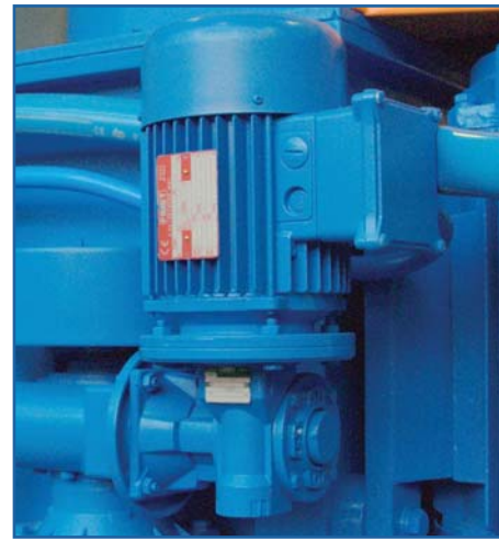
Upward/ descent motor reducer / abrasive working pressure. Motorreductor subida/bajada/presión de trabajo del abrasivo, junta rotante alimentación agua.
